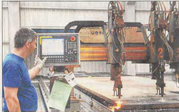
Die Autogenbrennanlage zum Schneiden von Stahl.
